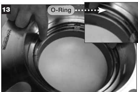
Den Dichtungsfansch behutsam umdrehen und auf ein sauberes Tuch legen, um die inneren Dichtungsfächen zu schützen. Eine dünne Fettschicht auf den restlichen Gleitring-O-Ring (X) auftragen und diesen in der Nut am Innendurchmesser des Dichtungsfanches montieren.
