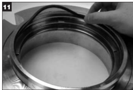
Eine dünne Fettschicht auf den Gleitring-O-Ring (X) auftragen und diesen in der Nut am Innendurchmesser des Adapters montieren.
