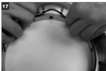
Eine dünne Fettschicht auf den O-Ring (Y) des Klemmrings auftragen und diesen in die Nut für den Klemmring am Innendurchmesser einsetzen.
