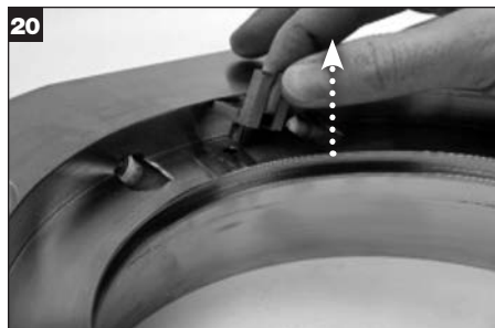
Die Mitnehmerbaugruppe aus dem Dichtungsflansch ausbauen und entsorgen.
