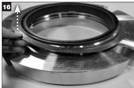
Die Dichtung aus dem Adapter entfernen und entsorgen.
