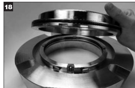
Den Adapter aus dem Dichtungsflansch entfernen und entsorgen. Den O-Ring (Z) des Adapters entfernen und entsorgen. Den Adapter zur Seite legen.
