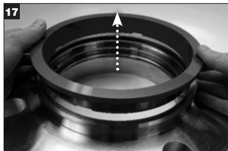
Den inneren Dichtungsring (Gegenring) aus dem Dichtungsflansch ausbauen und entsorgen.
