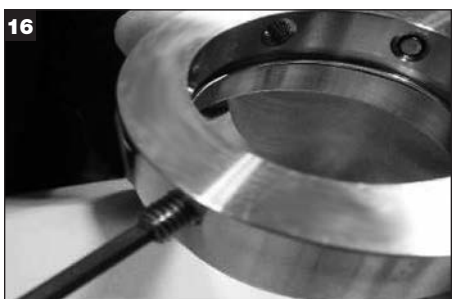
WICHTIG: Die Einstellschrauben dürfen nicht über den Innendurchmesser des Klemmrings hinaus vorstehen, bevor sie auf der Dichtungshülse montiert werden.
